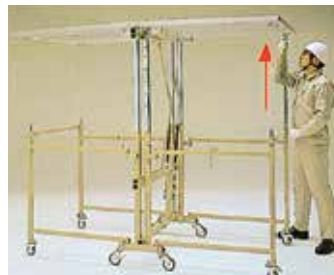
6 外脚の高低調整ピンを外し、外脚スライド脚の先端が天板の脚受けパイプにはまるように合わせ高低調整ピンを戻します。(4本)
