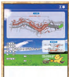
兵庫県光都土木仕様木枠看板(例) ●サイズ:H1800mm以上× W1700mm以上(脚300mm) ●材質:木枠トタン・間伐材製(脚付)
