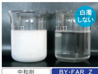
油を自然界のバクテリアが分解し易い超微粒子にまで加水分散させます。ひとたび分散された油分は再付着しませんので油紋やオイルボールが発生しません
