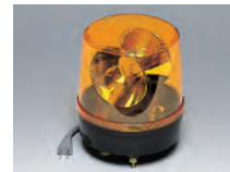
6250-Y ●黄 7625104 6250-R ●赤 7625102 回転灯 (AC100V) ●サイズ:φ186×H205mm ●重量:900g ●M8ボルト3カ所(φ140ピッチ) ●コード長さ:450mm
