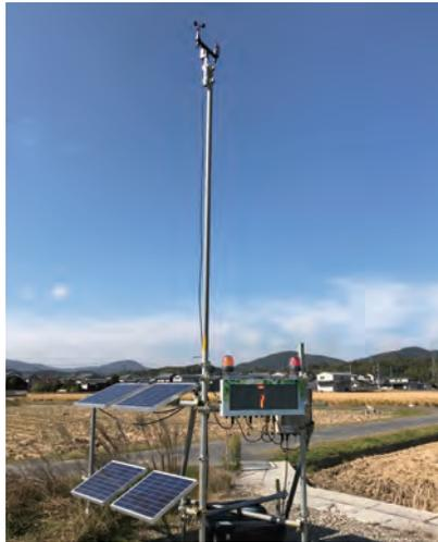
記録ch 風向風速計 風向風速表示機
